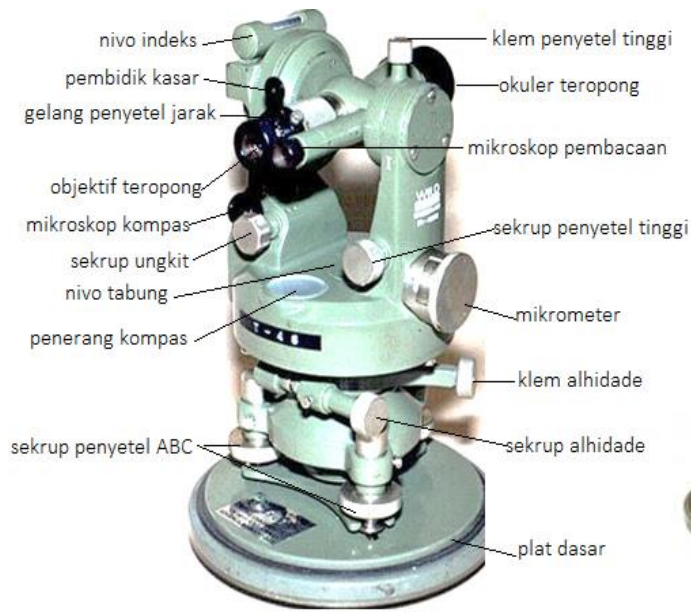
Gambar 6.1 Teodolit Wild T0 (dilengkapi dengan busolle)
