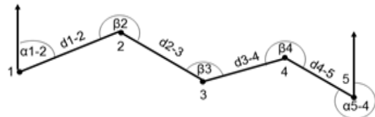
Gambar 4.9 Poligon terbuka terikat azimut
