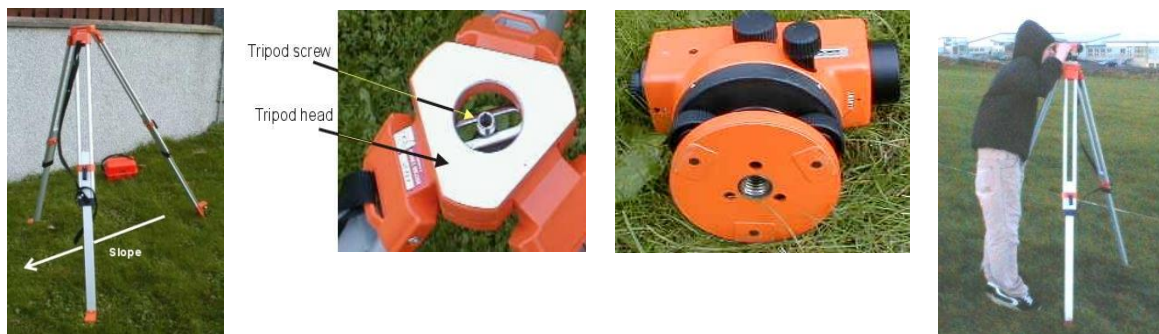
Gambar 7.12 Prosedur mendirikan tripod dan memasang waterpas
