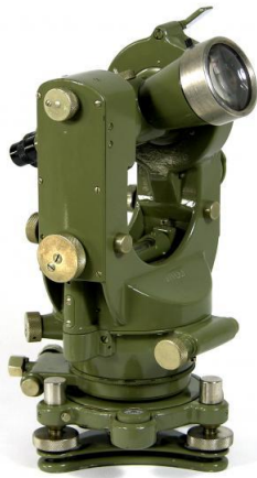
Gambar 6.3 Teodolit Wild T1. a). bacaan lingkaran horisontal 48^{\circ}22' b). bacaan lingkaran vertikal 89^{\circ}56'10''
