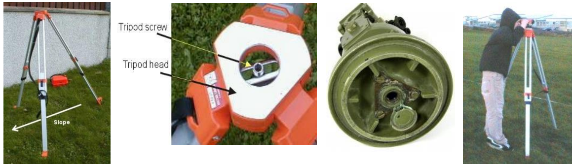
Gambar 6.4 Prosedur mendirikan tripod dan memasang teodolit
