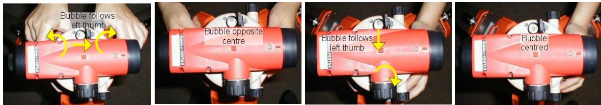
Gambar 7.13 Menyeimbangkan nivo kotak
